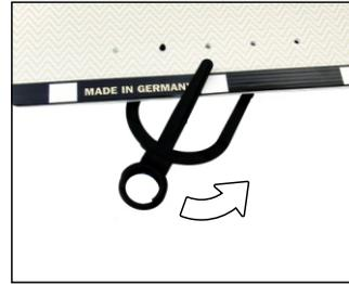
Montieren Sie die BOUNCE-WALL so auf die FORK-CLAMP, dass sich der mittlere Zinken vorne befindet. Stecken Sie dazu den Stift des ersten Zinkens in das zweite Loch von links und drehen Sie dann die Gabel so weit nach rechts bis die beiden anderen Stifte einrasten. Dabei muss die rechte Gabel zur Rückseite geführt werden.
