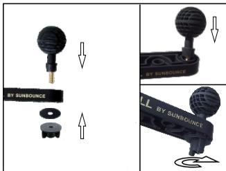
Falls noch nicht montiert, stecken Sie den BALL-HEAD in die äußere, dafür vorgesehene Öffnung. Der konische Zapfen sorgt für einen festen Sitz und verhindert ein Drehen des BALL-HEAD. Stecken Sie die Gummischeibe und die Kontermutter auf das Gewinde und ziehen Sie die Kontermutter leicht fest.
