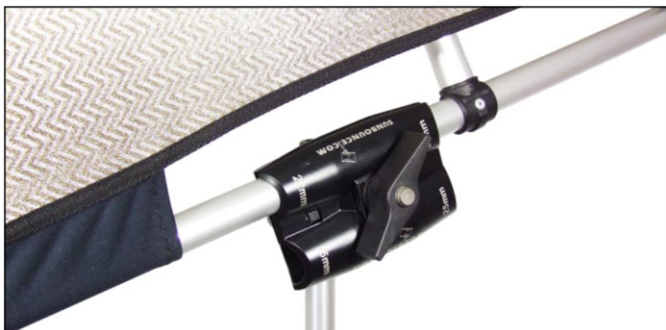
Lösen Sie die große Sicherungsschraube auf der Vorderseite des GRIP-HEADS und platzieren Sie den Reflektorrahmen in die passende Klemmbacke. Neigen Sie den Reflektor in die gewünschte Position und schrauben Sie die Sicherungsschraube fest zu.
