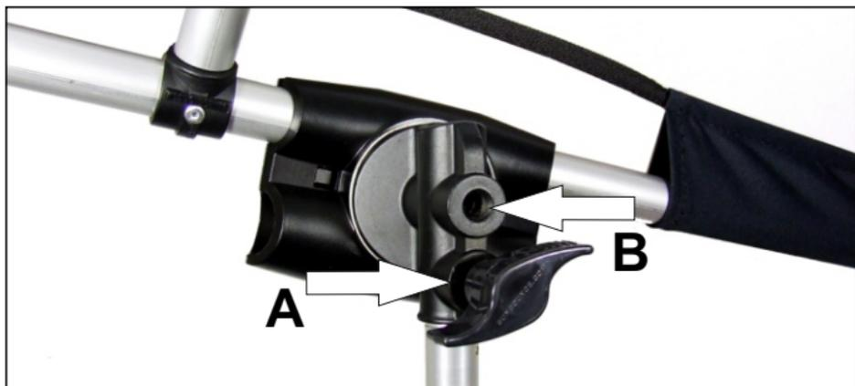
Stecken Sie den GRIP-HEAD auf den Verbindungzapfen des Leuchtenstativs. Je nach Länge des Verbindungzapfens können Sie die Sicherungsschraube in das passende Gewinde schrauben. Drehen Sie die Sicherungsschraube fest zu.
